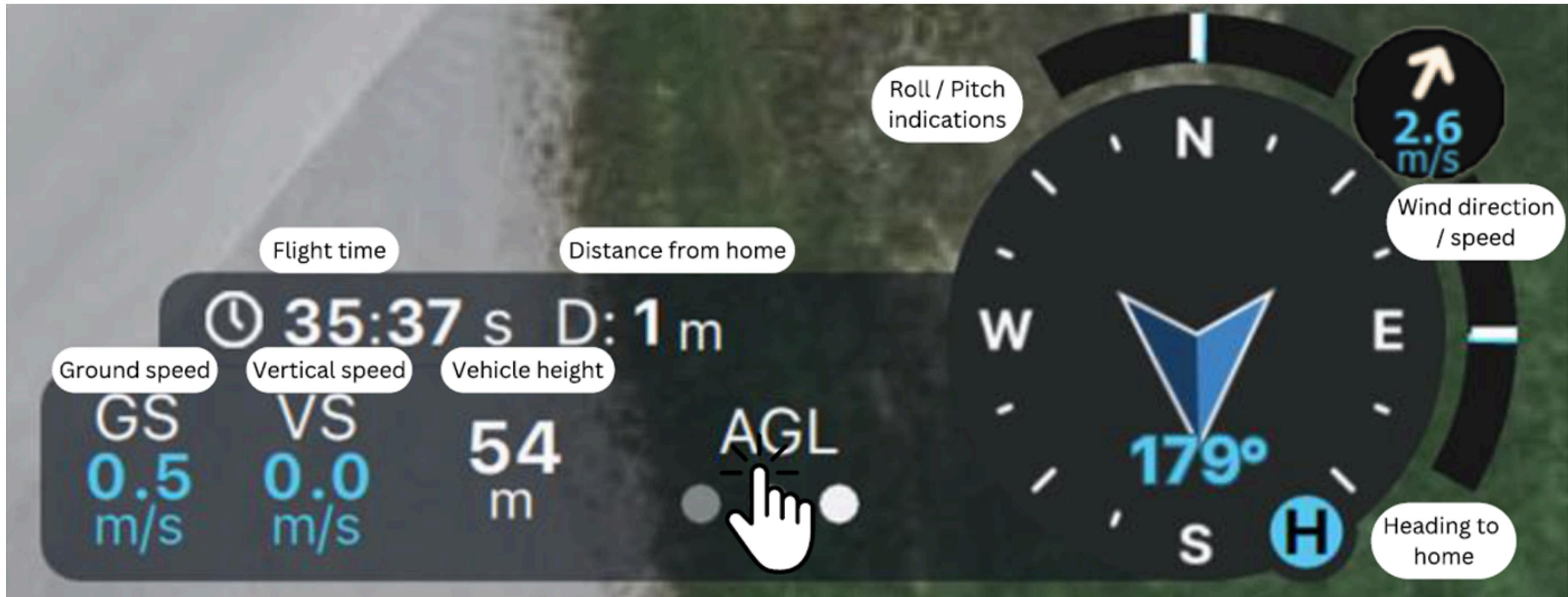
Das Telemetrie Dashboard zeigt die Geschwindigkeit, Flugzeit, Flughöhe und mehr. Per Click lässt sich das Referenzsystem für die Höhe ändern.
